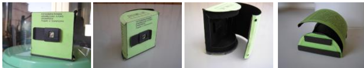
Apparecchio fotografico a foro stenopeico progettato da A. Scaramozzino (il modello esecutivo è stato disegnato con Word – vedi laboratorio "Word creativo")
